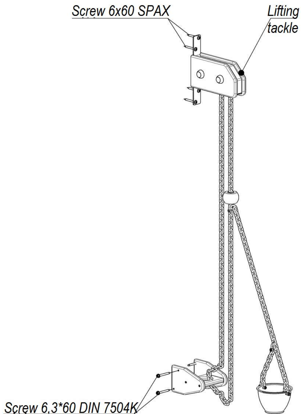
Picture 4 – «Lifting tackle» installation scheme
